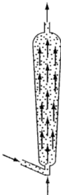
Figura 5-18 Reactor de transporte a través. [De V. W. Weekman, AIChE J. , 20, 833 (1974), con autorización de la AIChE. Copyright © 1974 AIChE. Todos los derechos reservados.]
